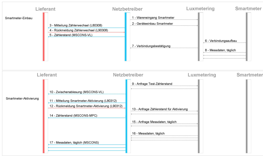
Abbildung 1.1.1: Sequenzdiagramm Aktivierung Smartmeter
